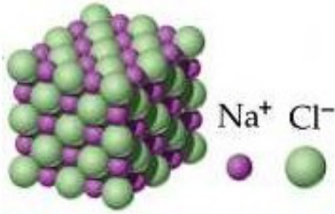
fig.6 Il composto ionico NaCl si forma quando gli elettroni dagli atomi di sodio sono trasferiti agli atomi di cloro. Gli ioni risultanti \text{Na}^+ e \text{Cl}^- formano una struttura tridimensionale che è mantenuta insieme da interazioni elettrostatiche attrattive
