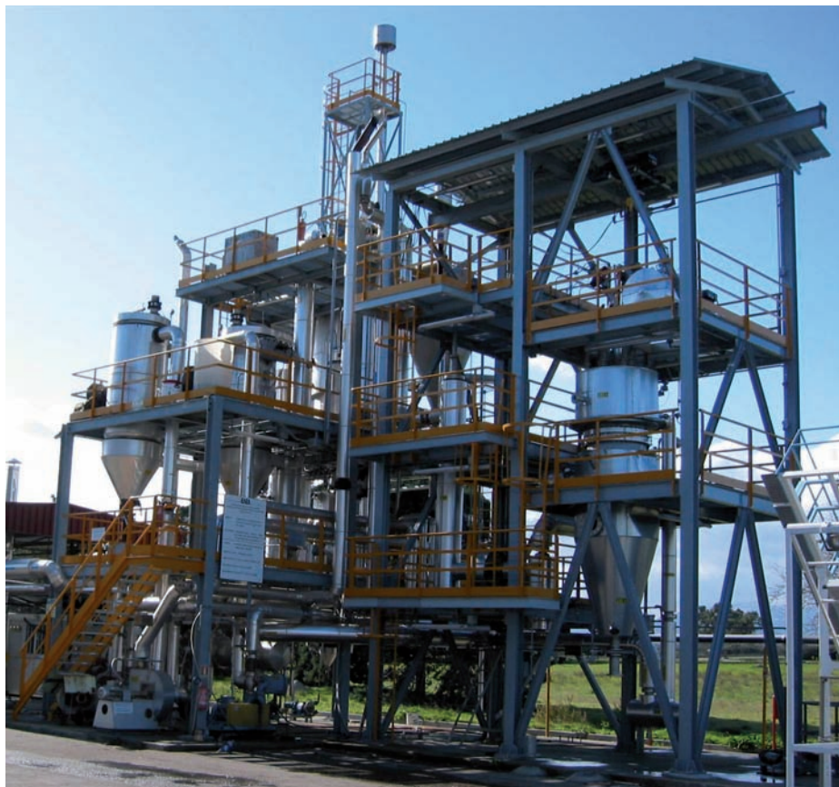
fig. 8. Impianto pilota di gassificazione delle biomasse a letto fluido ricircolante del centro ENEA della Trisaia (Rotondella, Matera).
