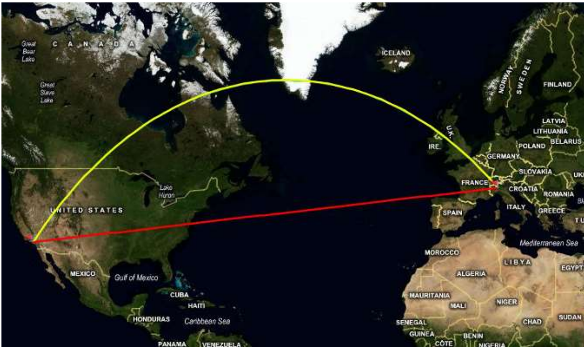
fig.9 Curva lossodromica (linea rossa) e ortodromica (linea gialla) secondo la proiezione conforme di Mercatore
