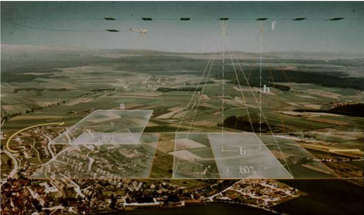
fig.4 Ricostruzione di una ripresa fotogrammetrica aerea
